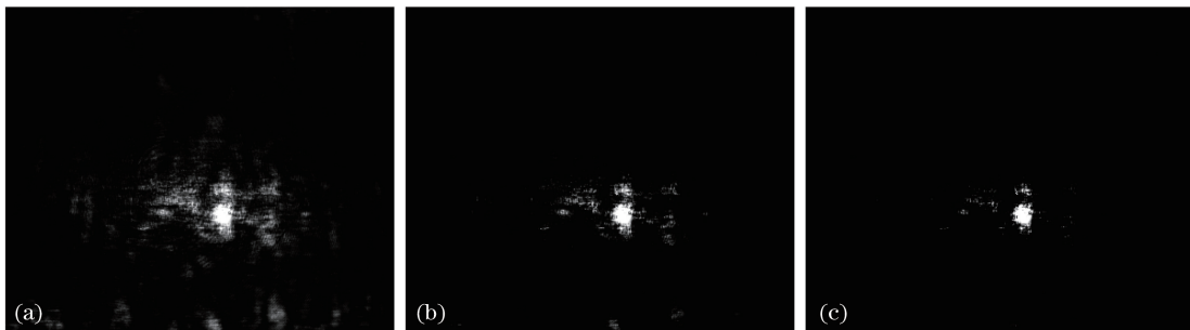
图 5 CCD 不同阈值下探测到的光信号。(a) CCD 灰度阈值为 25 level; (b) CCD 灰度阈值为 75 level; (c) CCD 灰度阈值为 128 level
