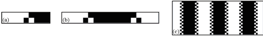
图 1 用传统方法产生二值图像。(a)优化后的 9 \times 2 二值块;(b)一个周期的二值图像;(c)完整的二值图像
