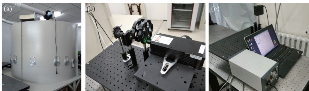
图 4 实验装置实物图。(a)烟雾环境模拟系统;(b)偏振光起偏系统;(c)偏振态接收系统
