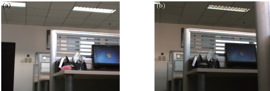
图 3 SENTECH 相机采集图像。(a) 曝光时间设置为 1/30 s; (b) 曝光时间设置为 1/60 s
