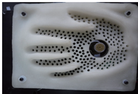
图 8 手掌固定装置 Fig. 8 Palm-restraining device
