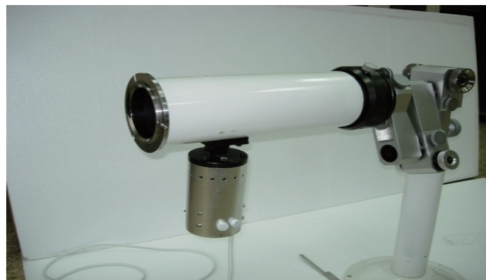
图 6 黑体照明光管实物图
