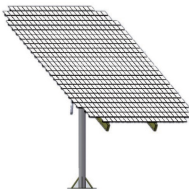
图1 多平面反射镜线性组合太阳能聚光器原理图
