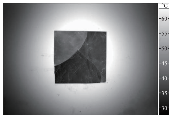
图 5 光子晶体迷彩红外热像图
