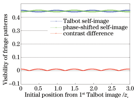
图 12 光谱范围为 360~370 nm 的汞灯光源入射时积分条纹图样的对比度
