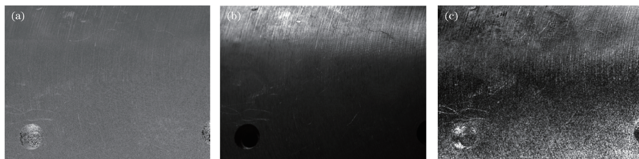
图 7 金属铝板实验结果。(a)强度图;(b)未修正反射率比;(c)修正后的反射率比
