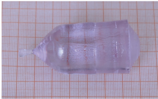
图 1 c 向生长 Nd:BaLaGa 3 O 7 晶体
