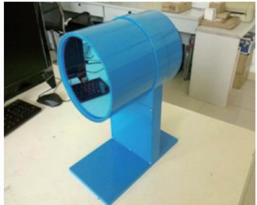
图 2 高灵敏度宽带紫外接收机(a)光路图及(b)实物图
