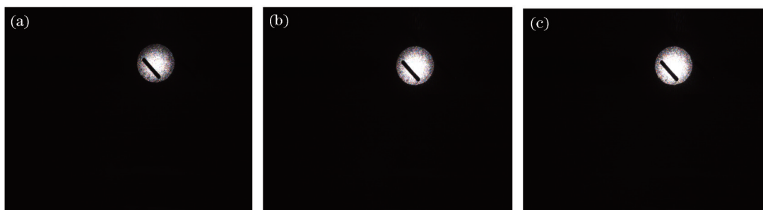
图 7 前向散射角为 40^\circ 时初始入射光为 -45^\circ 线偏振光的偏振。(a) 0^\circ ; (b) 90^\circ ; (c) 135^\circ
