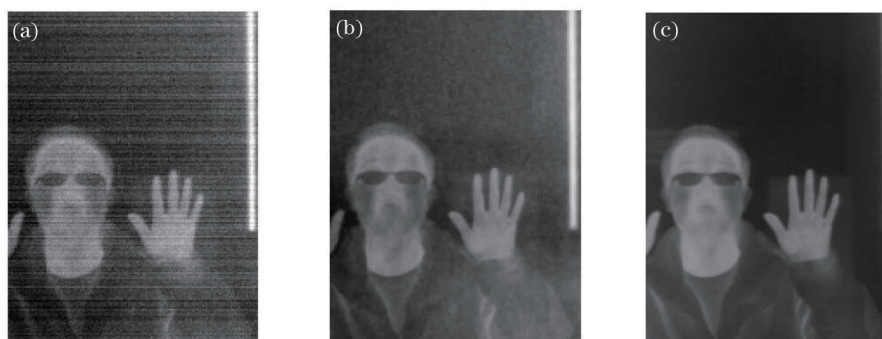
图7 目标局部放大图。(a)原始图像;(b)传统的神经网络法;(c)改进的神经网络法
