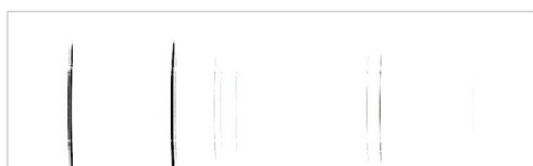
图6 氪光谱灯光谱图像
