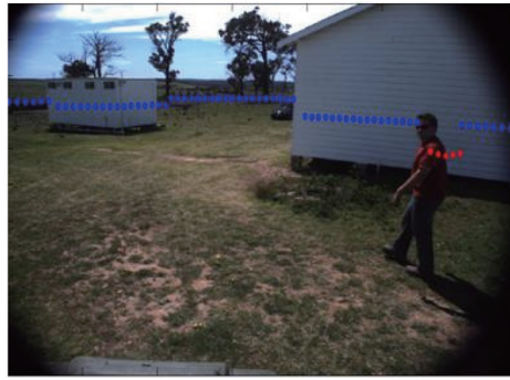
图 4 摄像机与激光测距仪联合标定参数误差作用效果图
