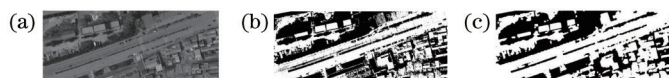
图 1 阈值分割后的道路影像。(a) 原始影像上的道路; (b) OTSU 自动阈值分割; (c) 影像形态分割结果 Fig.1 Road image with threshold segmentation. (a) Road in the original image; (b) segmentation with OTSU; (c) segmentation with morphology
