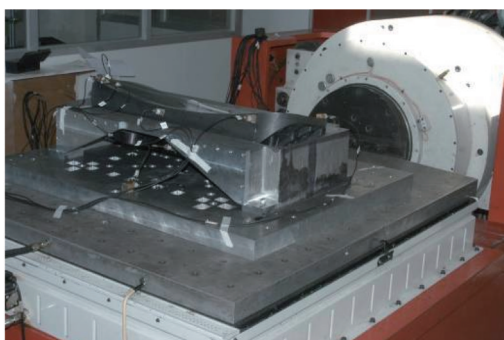
图9 反射镜组件正弦扫频实验
