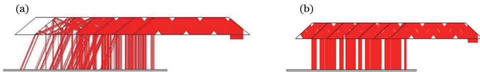
图 11 两种波导光线追迹。(a) 半透半反面波导; (b) 层叠阵列波导
