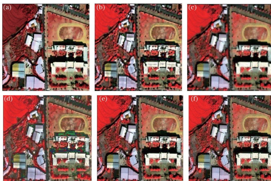
图 4 第 2 组不同方法融合后的图像。(a) IHS 变换;(b) NSCT 和 NMF;(c) IHS-Curvelet;(d) IHS-Shearlet;(e) NSCT 和 PCNN;(f) 本文方法
