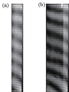
图 4 干涉条纹。(a)参考条纹;(b)实时条纹
