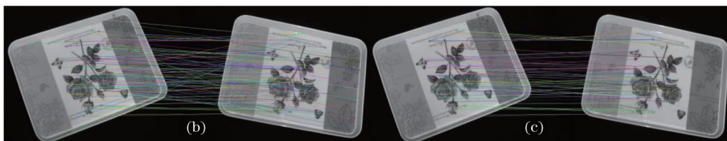
图6 特征点匹配。(a)几何特征点;(b)未采用RANSAC的图像对应点;(c)采用RANSAC的图像对应点
