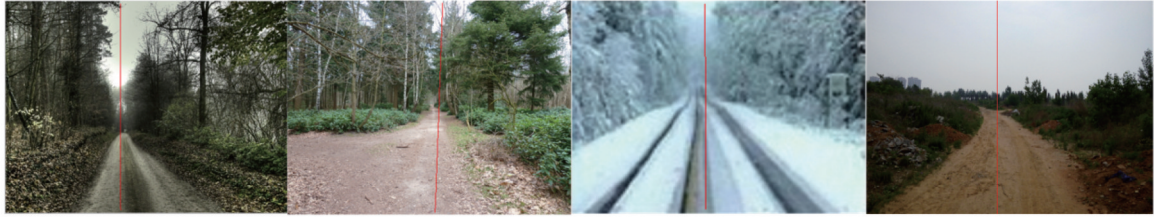
图7 不同环境的农业道路导航线提取结果
