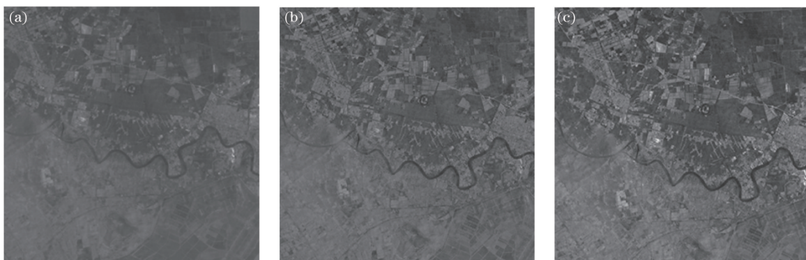
图9 不同方法复原图像结果。(a)原图;(b)ISO12233倾斜边缘法;(c)本文法
