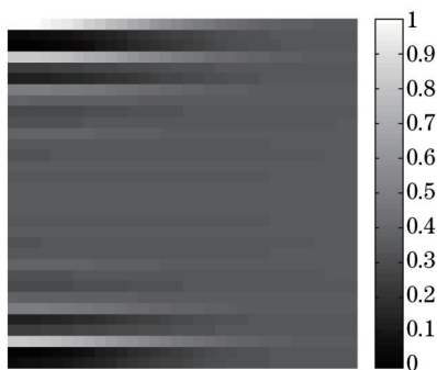
图6 \alpha=0 mrad对应的理想干涉图像
