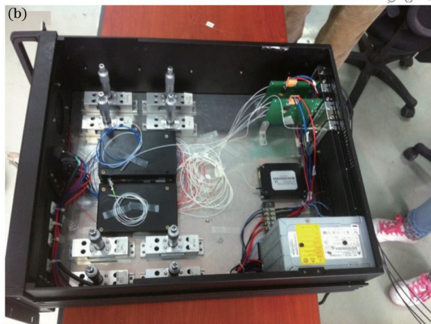
图 6 8 通道匹配光栅主机。(a) 结构图; (b) 实物图; (c) FBG 冻于冰样中
