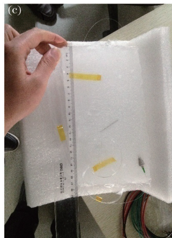
图 6 8 通道匹配光栅主机。(a) 结构图; (b) 实物图; (c) FBG 冻于冰样中
