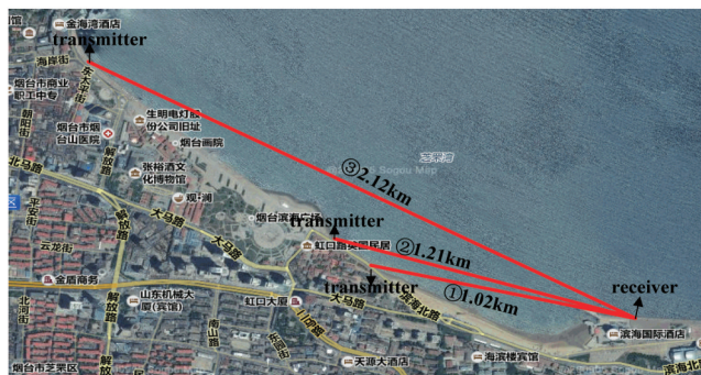
图 1 近海面准直光束漂移测试链路实际场景图(数据来源于 Sogou.com)
