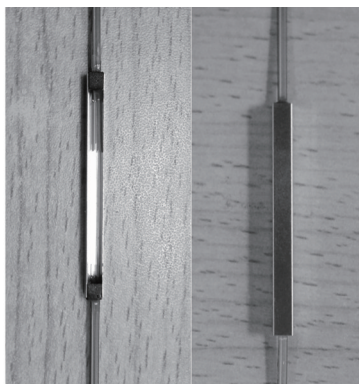
图9 阵列光栅封装。(a)装上底板的阵列光栅;(b)封装完成的阵列光栅
