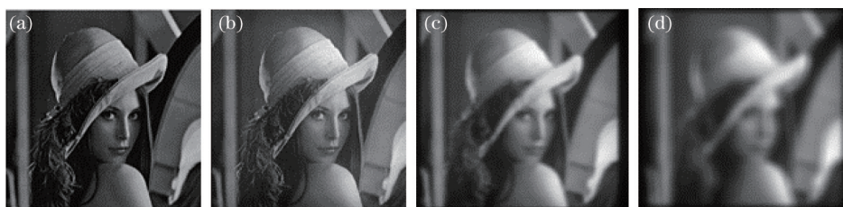
图9 不同角锥深度下角锥屏的成像模拟。(a) 原图;(b) d_{cca} = 10 \mu\text{m} ;(c) d_{cca} = 100 \mu\text{m} ;(d) d_{cca} = 150 \mu\text{m}
