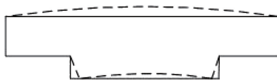
图4 背部结构对镜面变形的影响
