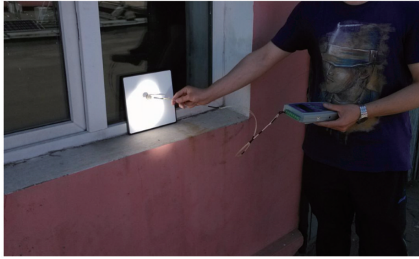
图8 运用热流计直接测量光斑能流
