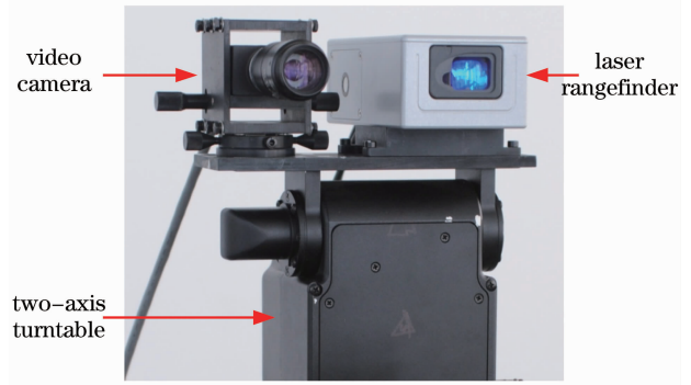
图1 基于两轴转台的点结构光测量系统
