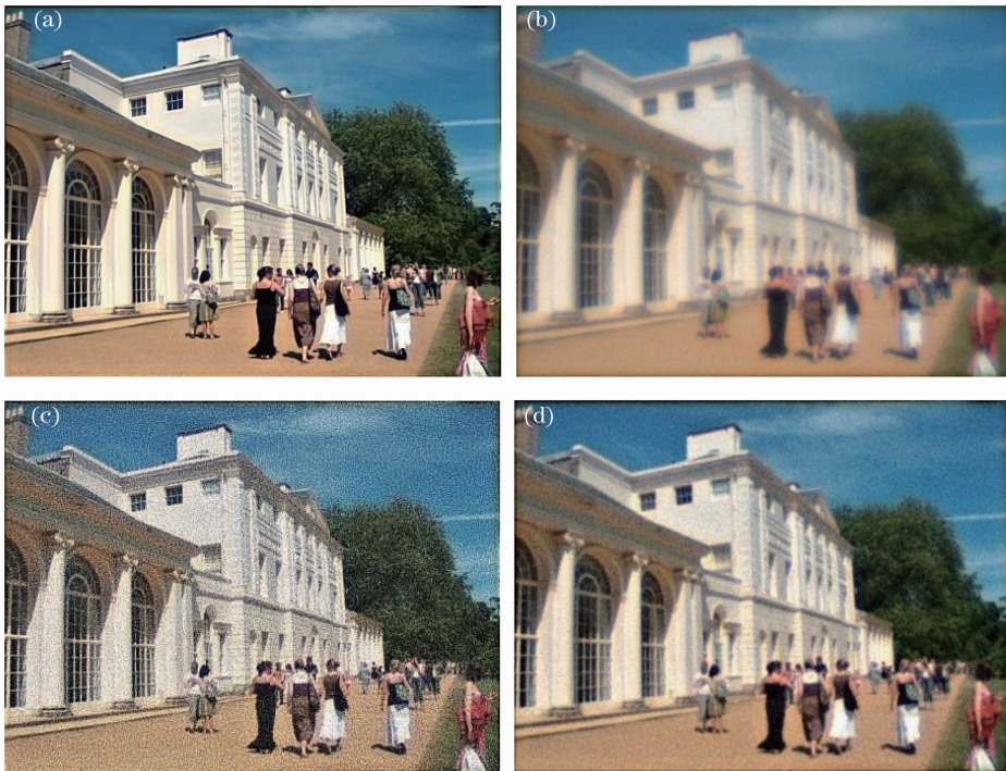
图 5 (a) 对图 4(b) 中的模糊图像使用维纳去卷积的结果; (b) 对图 4(b) 中的模糊图像加入均值为 0, 方差为 0.001 的高斯白噪声后的图像; (c) 维纳去卷积滤波器中的 N 为 0 时, 对图 5(b) 去模糊的结果; (d) 维纳去卷积滤波器使用正确的信噪比时, 对图 5(b) 的去模糊结果
