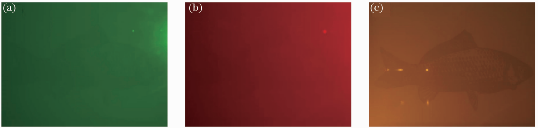
图5 加入牛奶和墨水的水中采集图像的对比。分别采用照明光源为(a)绿光;(b)红光;(c)黄色
