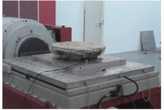
图 12 主反射镜组件动力学实验现场 Fig. 12 Dynamic test layout of PMA
