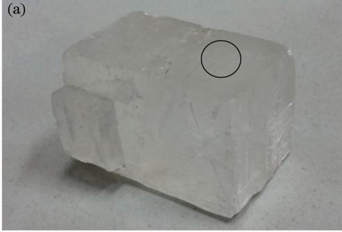
解石作为成像样品,图 5 为实验所用方解石图片,其中图 5(a)为方解石实物图,扫描区域在圆圈标出的面上,图 5(b)是将实验所用方解石放置在反射式显微镜下拍摄的图片,物镜放大倍率为 5 倍,扫描区域与黑色方框中的区域相对应。
