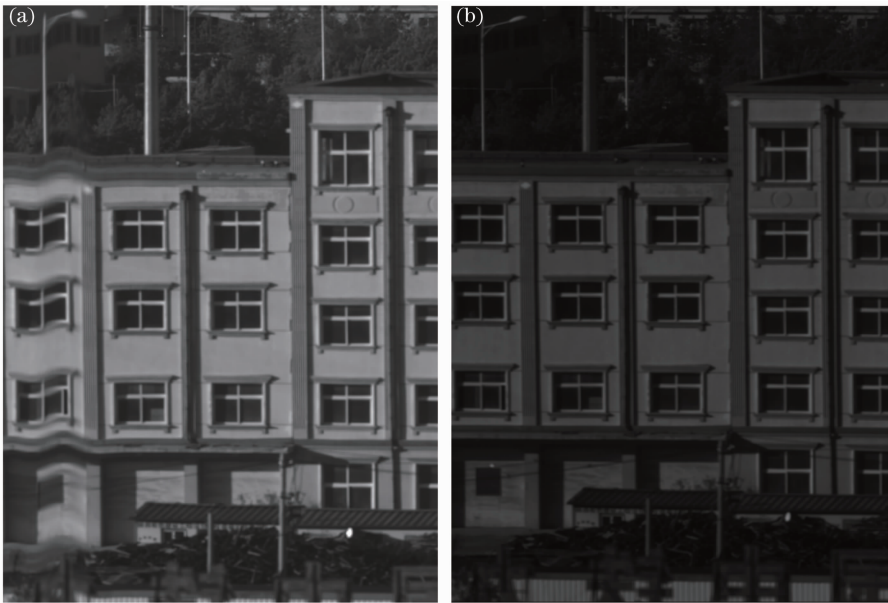
图 9 (a)并行控制下的外景图像;(b)高精度同步控制下的外景图像
