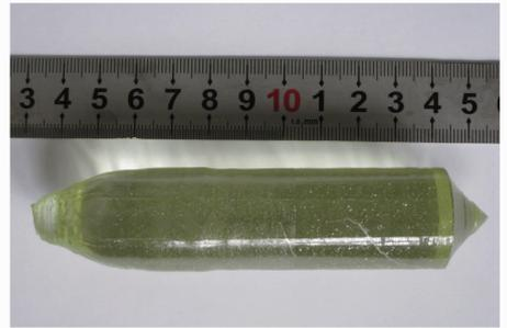
图1 生长的 Tm, Ho:LuAG 晶体
