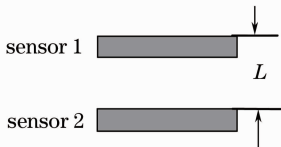
图 3 TDI 模拟相机焦面排布
