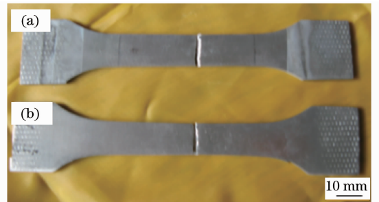
图 5 拉伸实验后的试样。(a)未经激光冲击; (b)激光冲击
