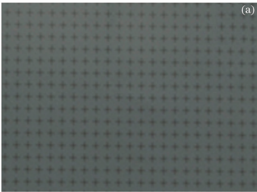
图 8 制备光学透明 FSS 用的 (a) 铬板和 (b) 样品照片
