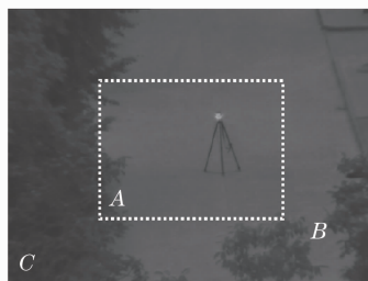
图 2 激光照射视场与成像探测视场比例关系
