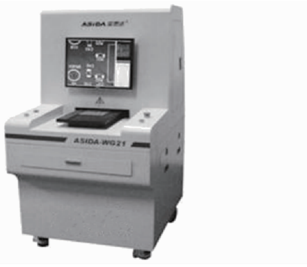
图 14 PCB 外观检查机原型
