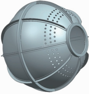
图 2 发光单元在积分球上的安装位置示意图
