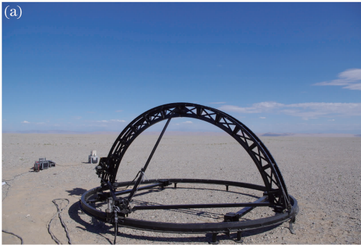
图 6 BRDF 测量系统。(a)实物图;(b)原理图
