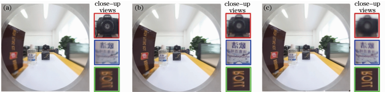
图 7 不同聚焦位置的实验效果图。(a)聚焦在全向图像内环;(b)聚焦在最佳聚焦平面;(c)聚焦在全向图像外环
