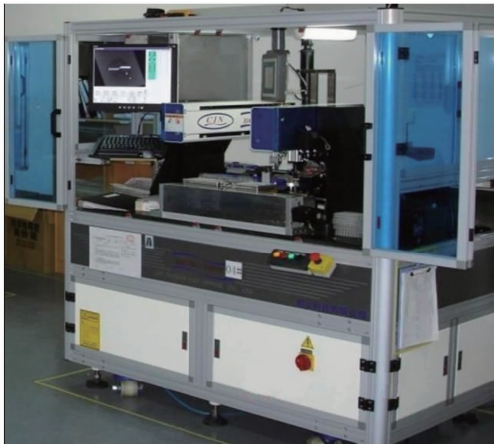
图 8 PCB 微钻头自动化检测系统
