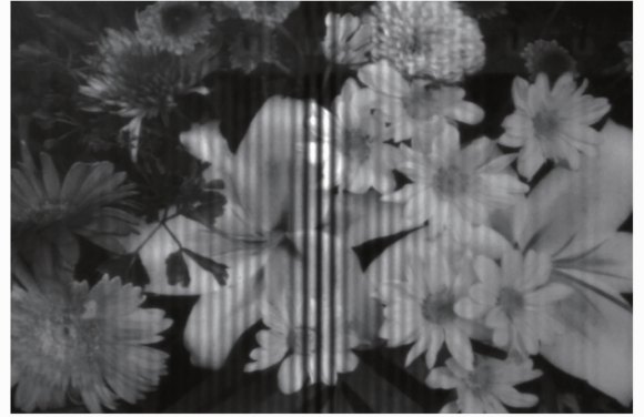
图1 光程差调制的干涉图像
