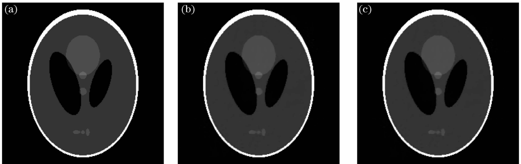
图 6 Shepp-Logan 模型与理想条件下的重建结果。(a) Shepp-Logan 模型; (b) ART-POCS-TV 算法; (c) ART-BOS 算法
