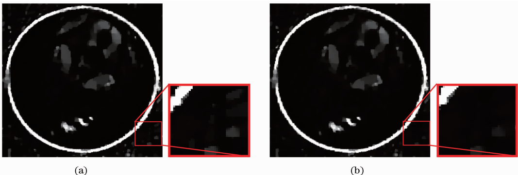
图11 蜜蜂样品的重建断层。(a) ART-POCS-TV算法;(b) ART-BOS算法
