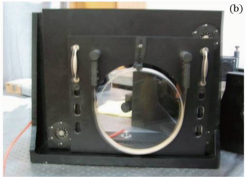
图5 (a) 测试系统实物图; (b) 五维气浮调整平台实物图
